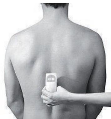
Das Gerät misst Länge und Winkel jeden berührten Rückenpunkts relativ zum Körperlot und übermittelt die Daten per Funk an den Computer.
